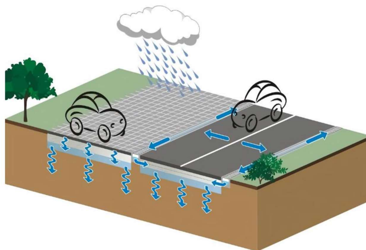
FIGURE 1 : MASSIFS STOCKANTS INFILTRANTS : A GAUCHE, PARKING POREUX ; A DROITE, CHAUSSEE RESERVOIR A INJECTIONS D'EAU LATERALES (SOURCE : SITE BRUXELLES ENVIRONNEMENT)
